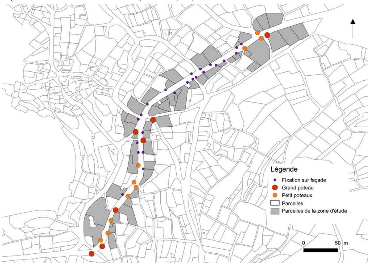
Fig. 24. Relevé des poteaux et connexion électrique sur la rue principale
